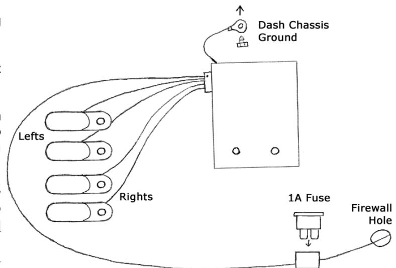
**Illustration 1: Wiring Diagram**
