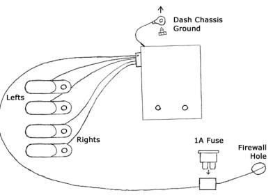
**Illustration 1: Wiring Diagram**
